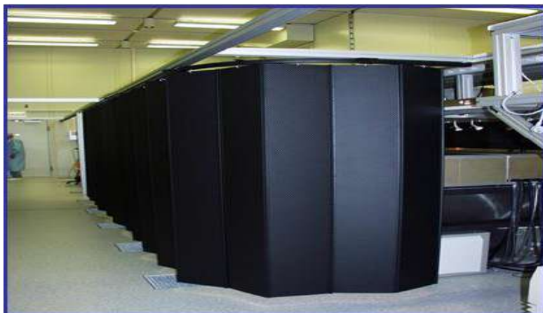
شکل ۶۸ - جداسازی محیط دستگاه لیزر در حین فعالیت با استفاده از موانع
