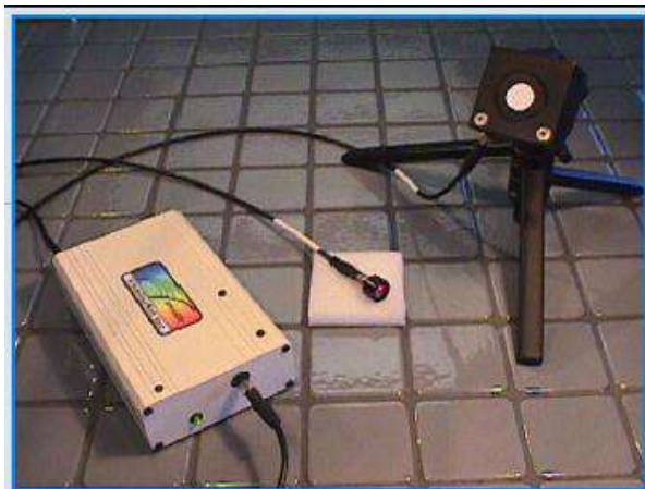
شکل ۱۴- نمونه دستگاه اسپکترو رادیومتر فرابنفش
