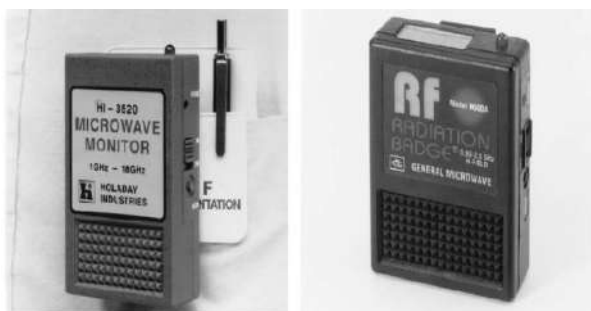
شکل ۳۴- پایشگرهای فردی امواج مایکروویو و رادیو فرکانسی
