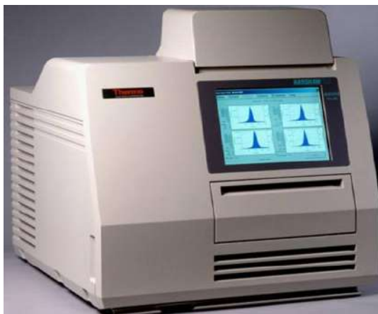
شکل ۸۸- دستگاه قرائت دز بر اساس مکانیسم حرارت دهی
