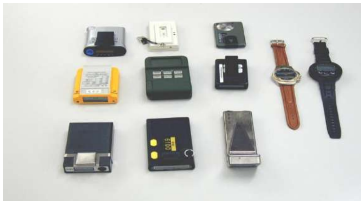
شکل ۸۳- دزیمرهای الکترونیکی قرائت مستقیم بر مبنای آشکارساز نیمه‌هادی
