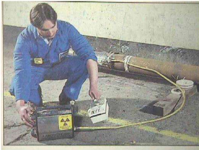
شکل ۸۱- اندازه‌گیری نشت پرتو در محل محفظه نگهدارنده منبع پرتوزا در پرتوکاری صنعتی
