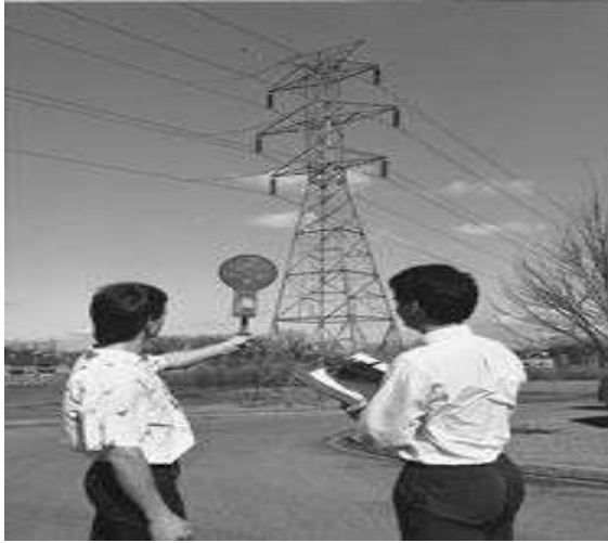
شکل ۴۷- روش اندازه‌گیری شدت میدان مغناطیسی اطراف خطوط انتقال نیرو
