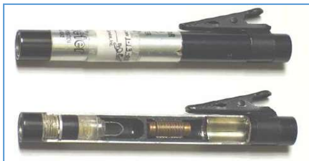
شکل ۸۹- دزیمر جیبی نوع قرائت شونده Self-Reading
