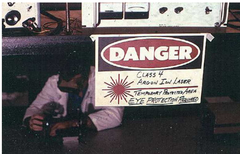
شکل ۶۹ - برچسب‌گذاری خطر در محیط کار با دستگاه‌های لیزر
