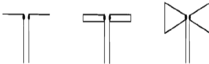
شکل ۳۱- آنتن دوقطبی کوچک به‌عنوان پروب میدان الکتریکی
