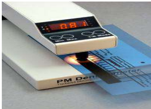
شکل ۸۴- دانسیتومتر جهت تعیین چگالی نوری فیلم
