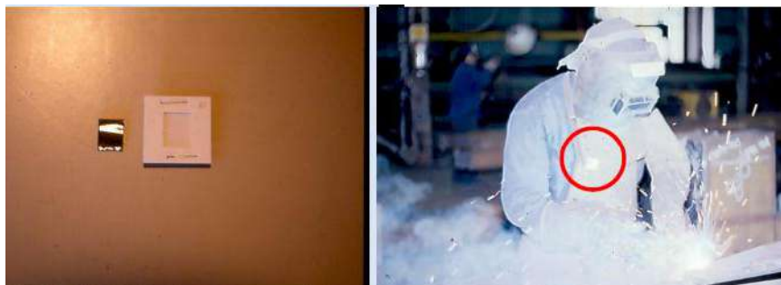
شکل ۱۶- دزیمتری پرتو فرابنفش با استفاده از فیلم Polysuphone
