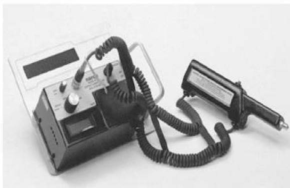
شکل ۳۹- دستگاه اندازه‌گیری شدت جریان تماسی
